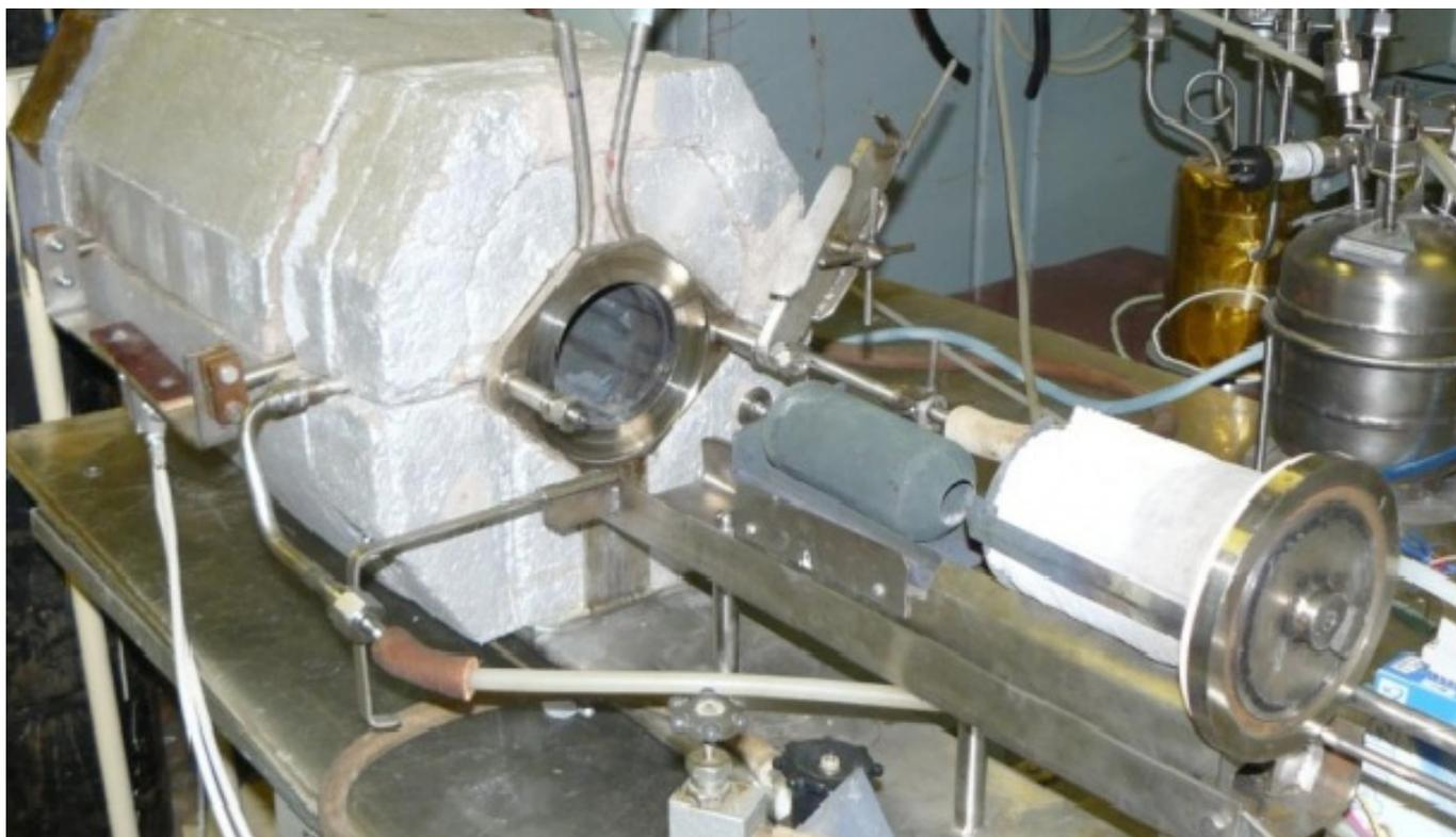
Рис. 11. Установка «Хруст». Вид нагревателя, ампулы для ОЯТ и пробки
