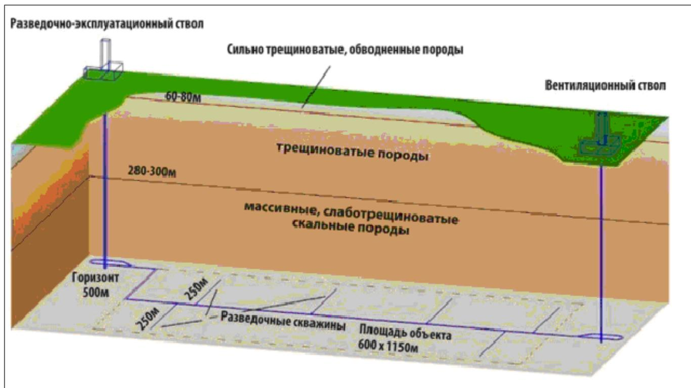
Рис. 16. Подземные сооружения и скважины ПИЛ
